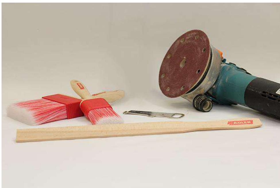
**Подготовка основания для наружной отделки финишное шлифование шлиф.шкуркой Р60 (чем грубее, тем эффектнее получится покрытие) вдоль волокон.** Обращать внимание, чтобы шкурка была предназначена для шлифования древесины.
